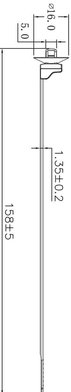
材质：采用UL认证尼龙66，防火等级94V-2、耐酸、耐腐蚀、绝缘性好、不宜老化、承受力强；
